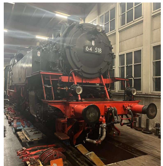
Die Aufgearbeiteten Teile der Bremse warten auf den Wiedereinbau. Foto: A.Machacek
